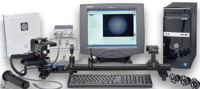
Instrumento de prueba de la calidad de imagen de endoscopios rígidos, flexibles y de video que consiste en un **sistema optomécanico y software** con capacidad de generación de reportes.
